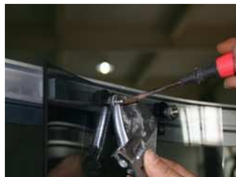
B-8 kinnitage kruvid nii et ukсед töötaksid sujuvalt
