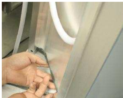
B-16.asetage alumiinium paneel keskele ja paigaldage plastic kaitse nagu näidatud
